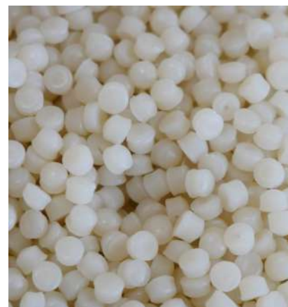
*リサイクル樹脂「INNOGREEN」写真：再生HDPE(透明グレード)
